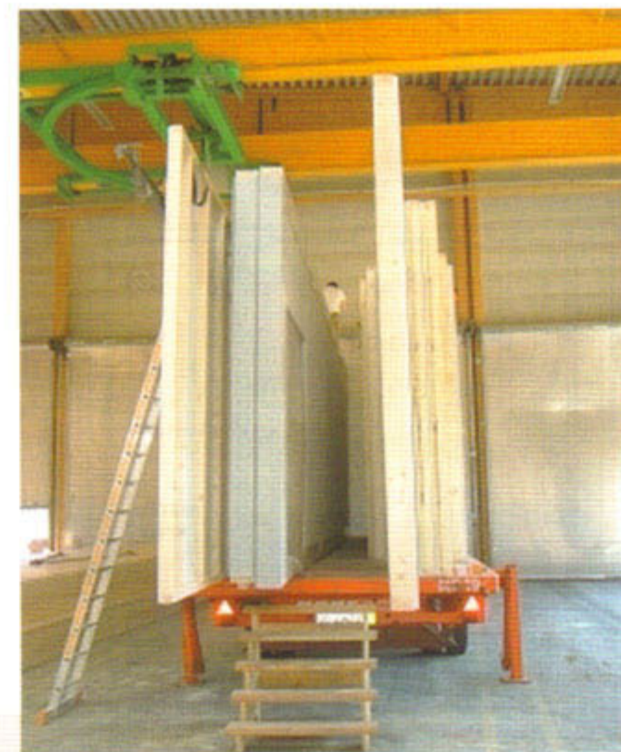
Vorfertigung – auch für mehrgeschossige Wohntypologien in der Stadt Quelle: TU Braunschweig IIKE
